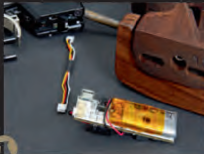
Kabel beim Elektronikmodul austauschbar (E)
