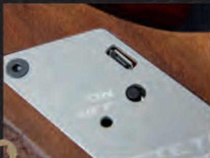
Aufladbarer Akku, Tasterschalter (E)
