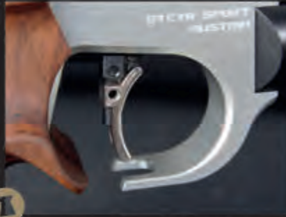
Vergößerter Abzugsbügel für Schützen mit längeren Fingern
